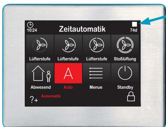
Eine zeitgesteuerte Filterüberwachung ist im Lüftungsgerät integriert und wird Ihnen im Bedienelement angezeigt:
